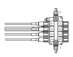
А1,А2,А3,А4,В3 - провод гидравлический № 24 В1,В4 - провод гидравлический № 25 В2 - провод гидравлический № 26
